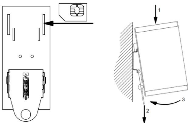
Die SIM-Karte ist vor dem Aufschrauben auf die Hutschiene auf der Rückseite des Gerätes im ausgeschalteten Zustand einzusetzen.
